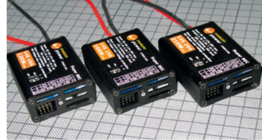
Die Chargey Power Super BEC's mit 10, 15 und 20 Ampere Dauerleistung
