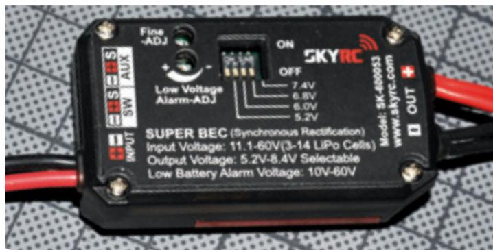
Die Rückseite des 10A Super BEC mit den vier Mikroschaltern zur Spannungswahl und den zwei Trimpotis zur Grob- und Feinjustierung der Alarmschwelle bei Unterspannung im Eingangsbereich
