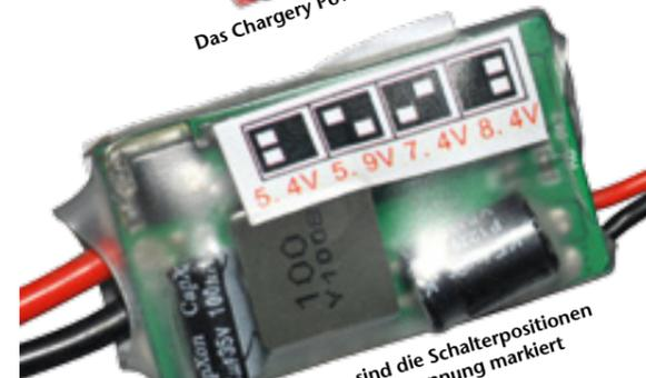
Auf der Unterseite sind die Schalterpositionen zur Wahl der Ausgangsspannung markiert
