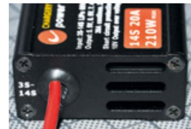
Rückseite der Chargey BEC's mit Lüftungsschlitzen
